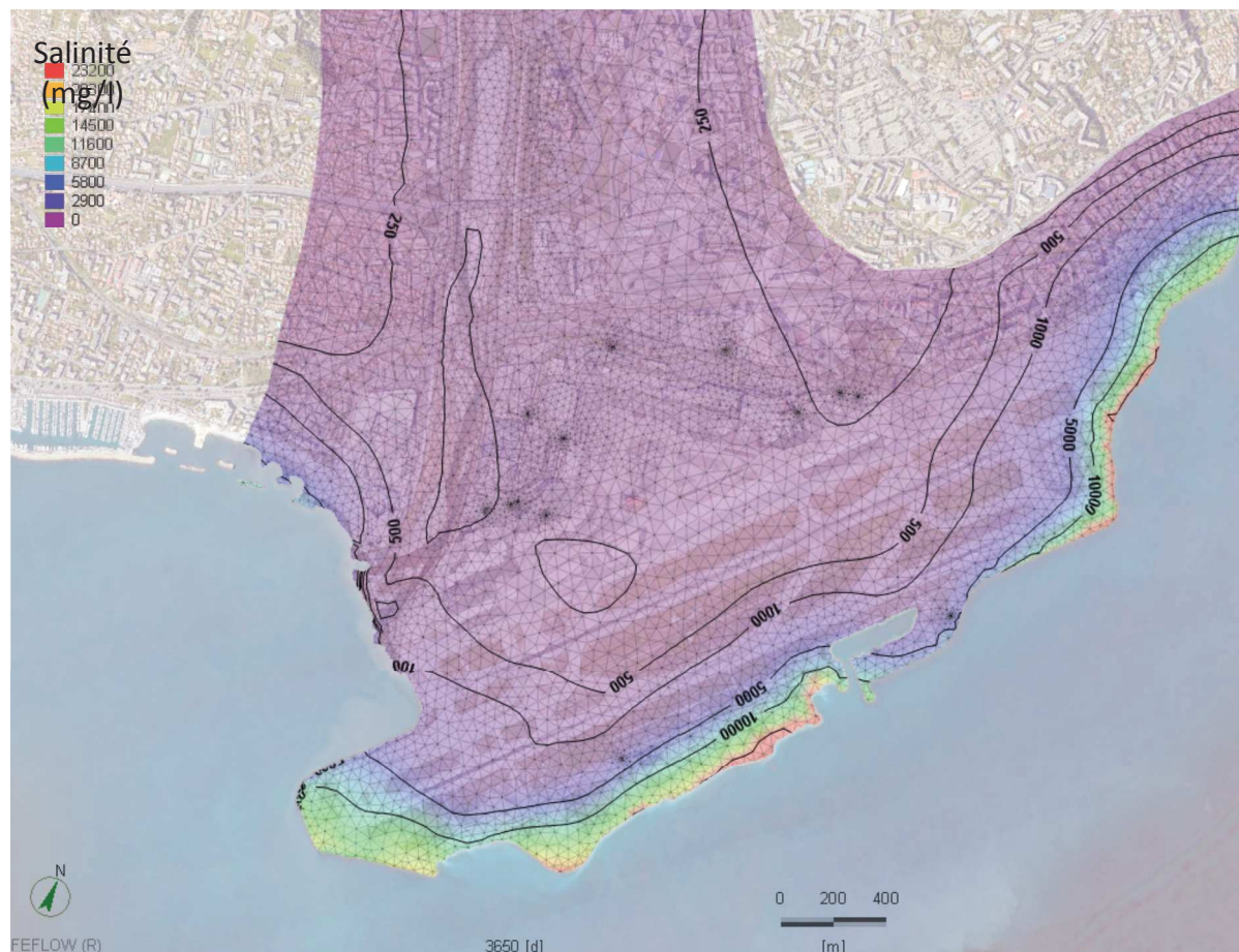
Figure 12 : Salinité calculée par AquaVar pour la nappe superficielle pour les usages actuels.
