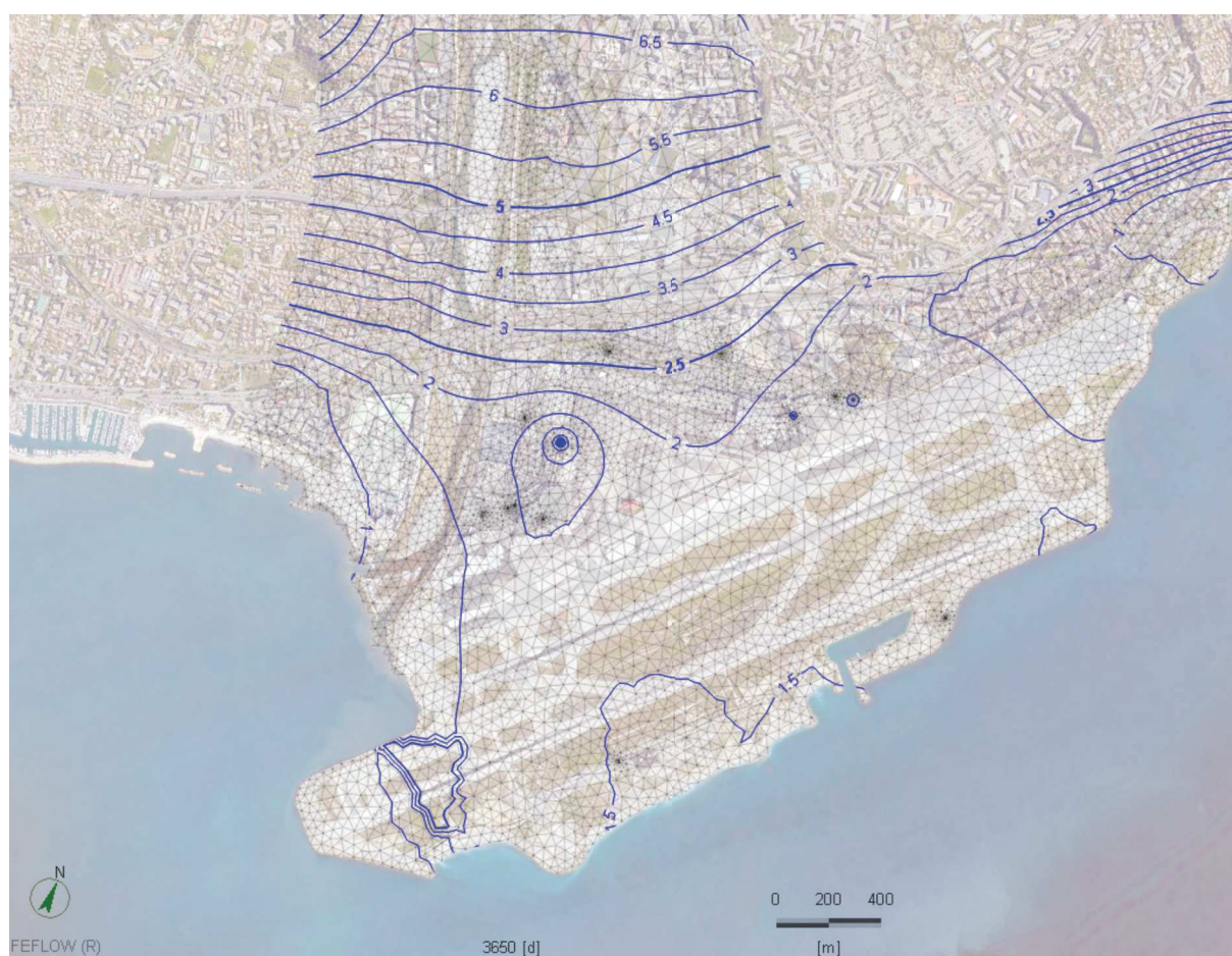
Figure 19 : Isopièzes calculées par AquaVar pour la nappe profonde avec les usages actuels.
