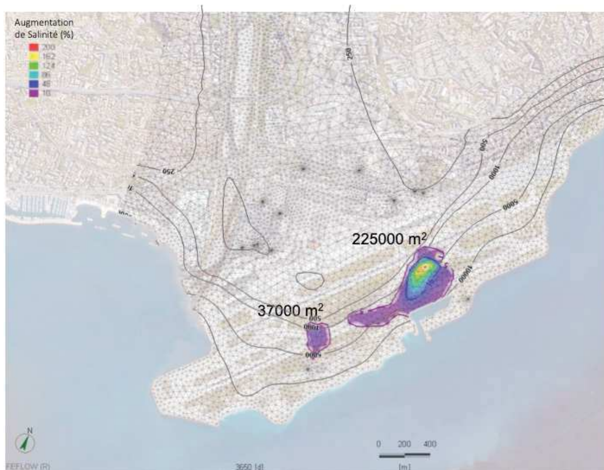
Figure 24 : Augmentation de la salinité (%) calculée par AquaVar pour la nappe profonde induite par les usages actuels.
