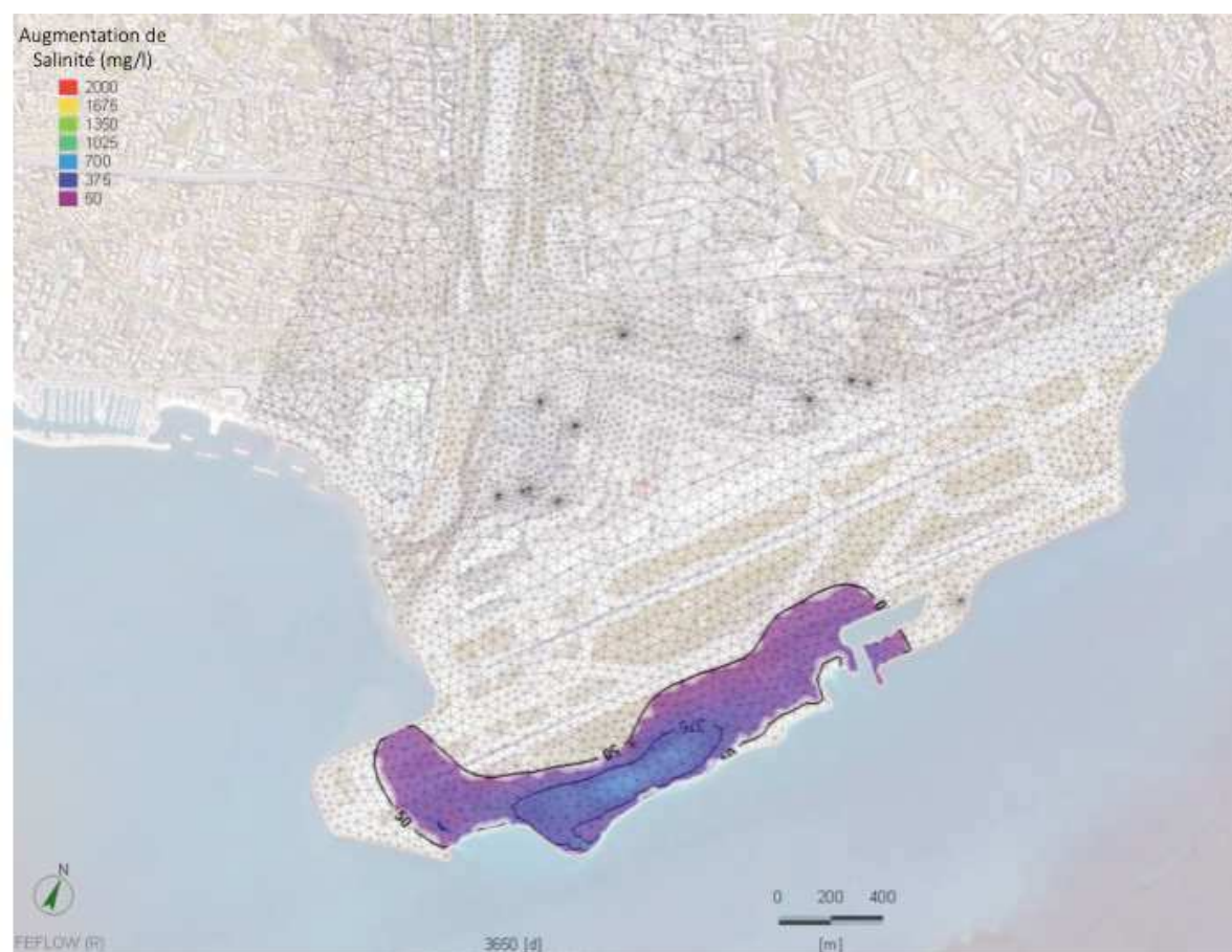
Figure 13 : Augmentation de la salinité (valeur absolue) calculée par AquaVar pour la nappe superficielle induite par les usages actuels.
