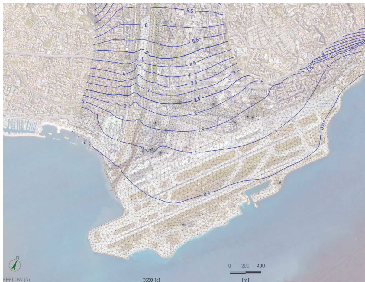
Figure 10 : Isopièthes calculées par AquaVar pour la nappe superficielle avec les usages futurs.
