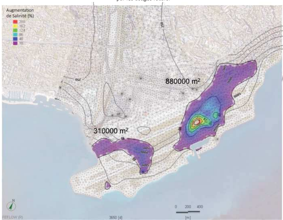
Figure 27 : Augmentation de la salinité (%) calculée par AquaVar pour la nappe profonde induite par les usages futurs.
