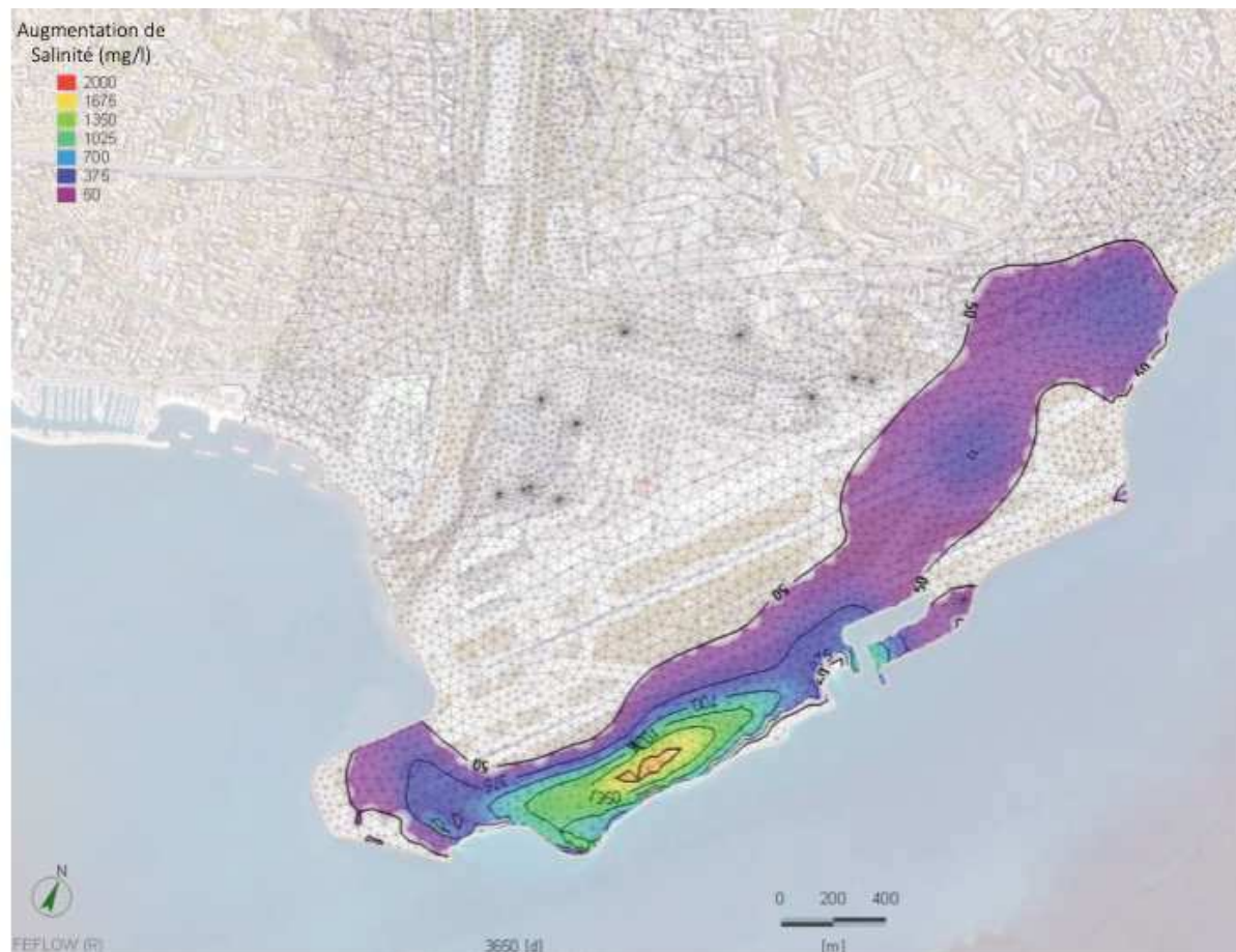
Figure 16 : Augmentation de la salinité (valeur absolue) calculée par AquaVar pour la nappe superficielle induite par les usages futurs.
