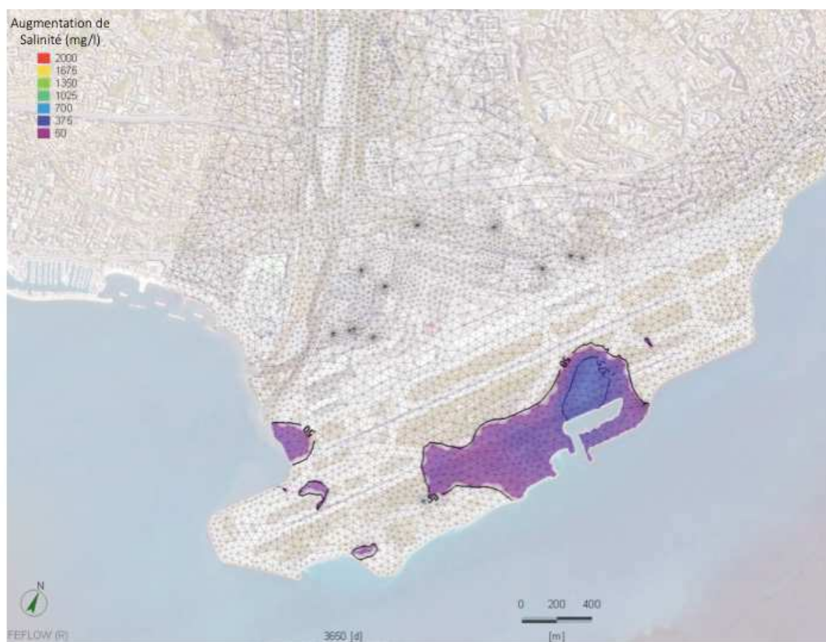
Figure 23 : Augmentation de la salinité (valeur absolue) calculée par AquaVar pour la nappe profonde induite par les usages actuels.
