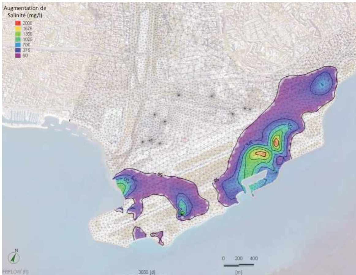
Figure 26 : Augmentation de la salinité (valeur absolue) calculée par AquaVar pour la nappe profonde induite par les usages futurs.
