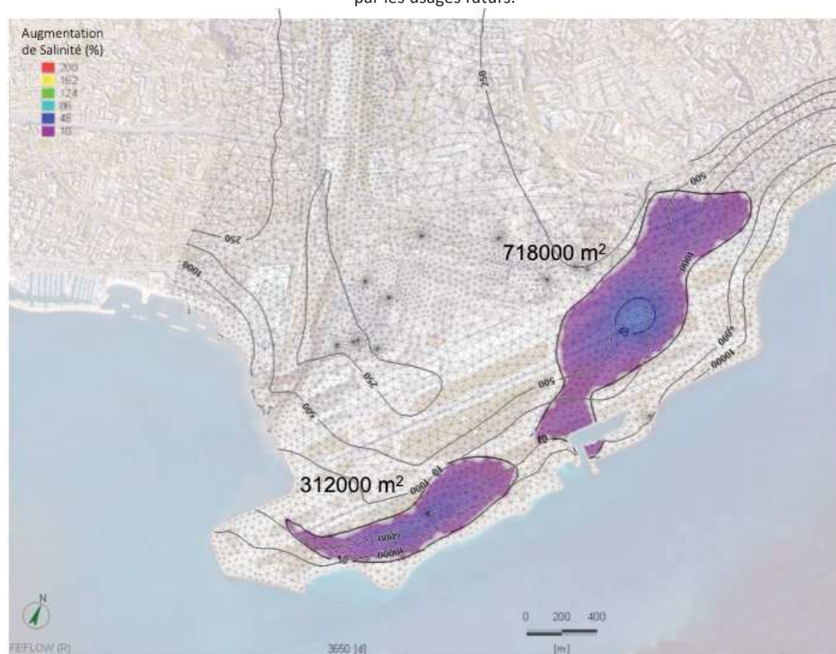
Figure 17 : Augmentation de la salinité (%) calculée par AquaVar pour la nappe superficielle induite par les usages futurs.
