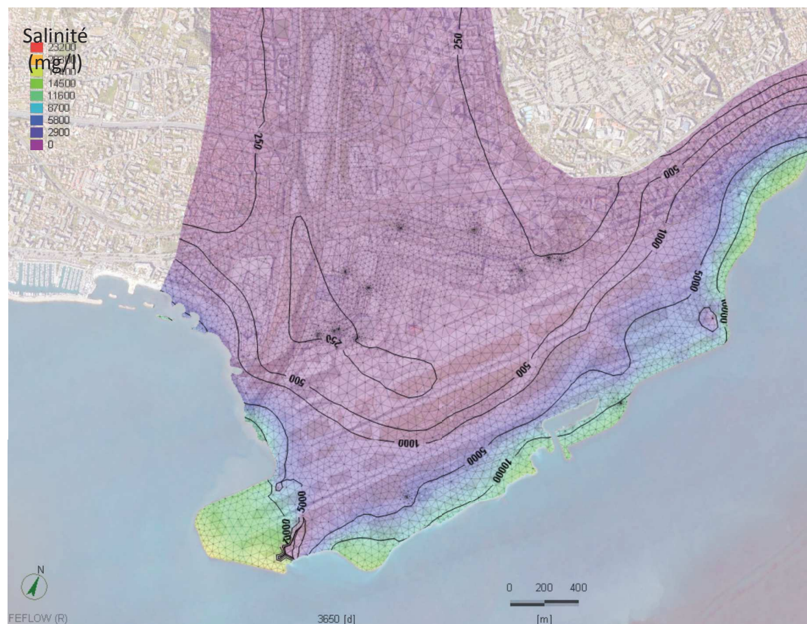
Figure 25 : Salinité calculée par AquaVar pour la nappe profonde induite par les usages futurs.
