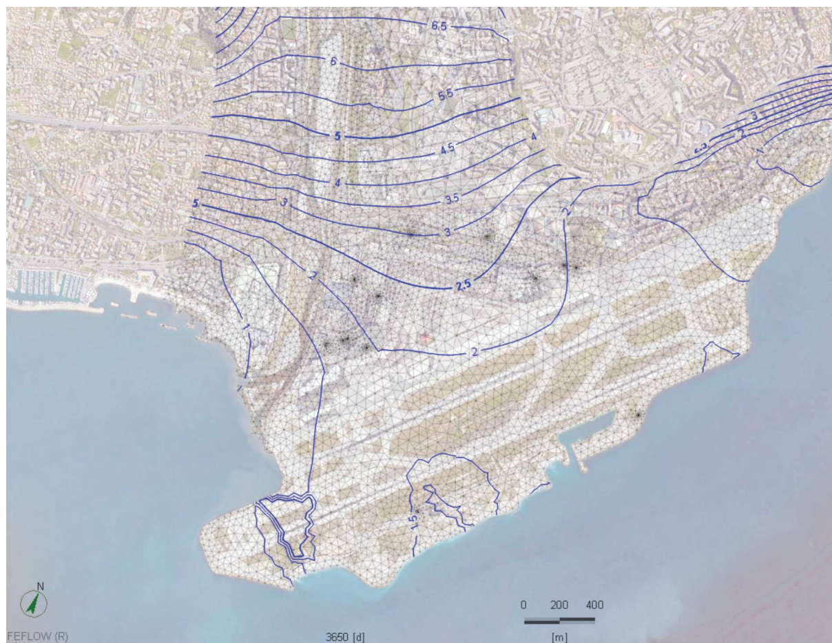
Figure 18 : Isopièzes calculées par AquaVar pour la nappe profonde sans prélèvement.
