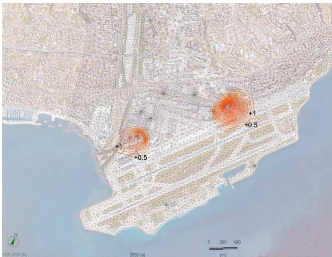
Figure 32 : Impacts sur la température de la nappe profonde calculés par AquaVar pour les usages actuels.
