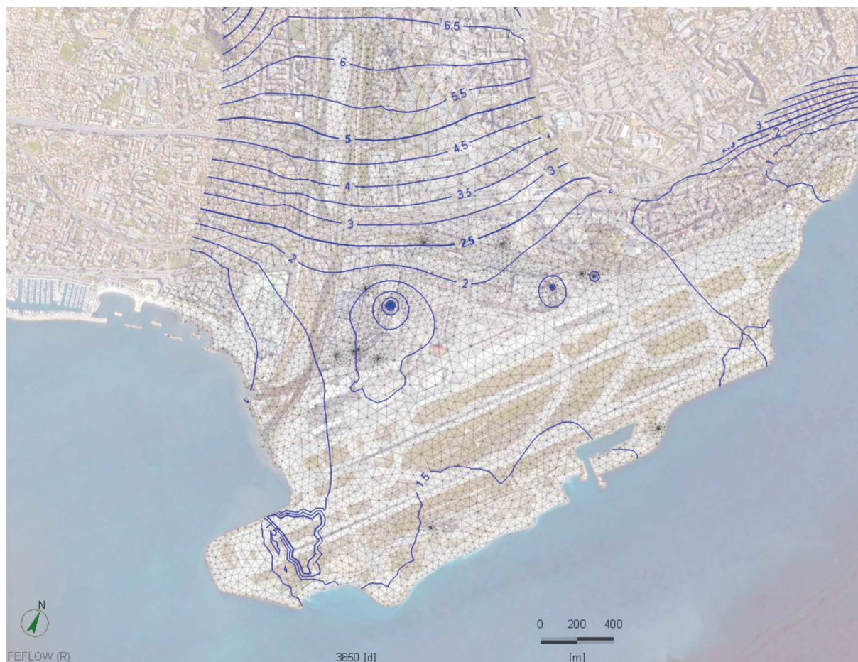
Figure 20 : Isopièthes calculées par AquaVar pour la nappe profonde avec les usages futurs.
