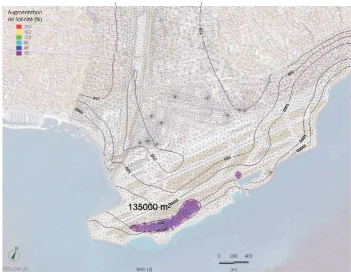
Figure 14 : Augmentation de la salinité (%) calculée par AquaVar pour la nappe superficielle induite par les usages actuels.
