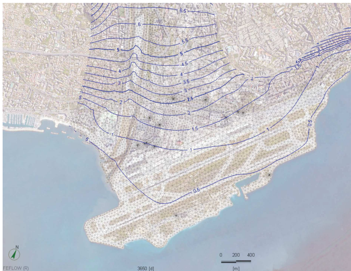
Figure 8 : Isopièzes calculées par AquaVar pour la nappe superficielle sans prélèvement.
