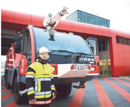
En 2011, le SSLIA (Service de Sauvetage et de Lutte contre l'Incendie des Aéronefs) a reçu un nouveau « VIM 90 » fabriqué par SIDES, l'un des grands spécialistes mondiaux des véhicules anti-incendie. Ce camion est doté d'une technologie innovante dite de « mousse sèche ». Cette nouvelle génération de mousse permet une très bonne tenue de l'agent extincteur sur les fuselages des aéronefs. **Nice Côte d'Azur est le premier aéroport français à s'équiper d'un tel véhicule.**
